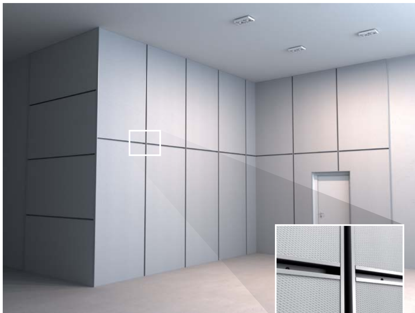
7.1 Ferdigmonterte VertiQ-plater og hatteprofiler.
